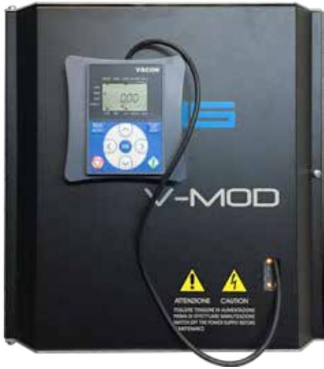
V\_MOD est un dispositif qui permet de transformer facilement les anciens ascenseurs à 1 ou 2 vitesses par une commande à vitesse variable (VVVF) sans remplacer le treuil, moteur, tableau de commande et l'installation électrique de la gaine et de la cabine.
