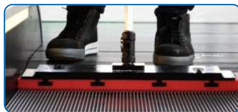
Le défilement de l'escalier mécanique rend le lavage simple et efficace.
