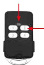
Choisir une touche sur l'émetteur PRO-4T, enfoncer cette touche puis relâcher la. Cela permet d'enregistrer les informations de la télécommande originale. La LED devient orange. (exemple sur le schéma avec la touche 2).
