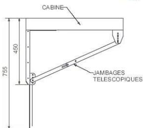
3° Mettre en place les **2 jambages télescopiques** (indice D) sur le corps du chasse-pieds (se servir des trous disponibles pour avoir un réglage optimale).
