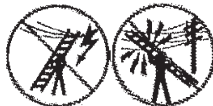
Attention aux risques électriques lors du déplacement de l'échelle
