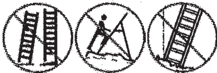
Dresser sur une surface plane
